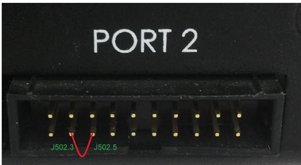
图 4.LS1021A-IoT 上的 GPIO24 和 GPIO25 连接
