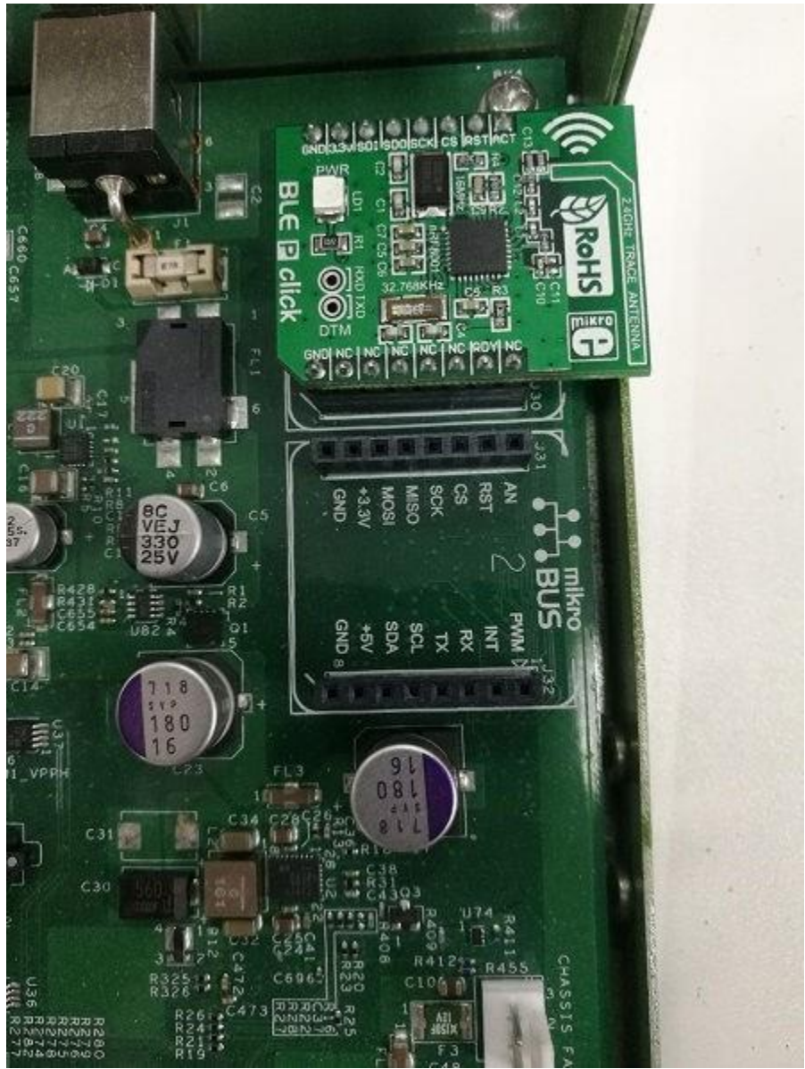
图 61.BLE P click 板硬件设置
