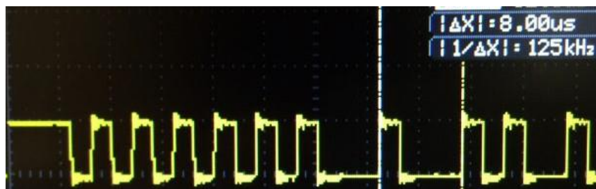
图13.标准ID为0x555的CAN 2.0传输帧开始处的TxD引脚
