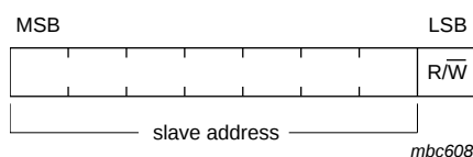
図 10. スタートプロセス後の最初のバイト
