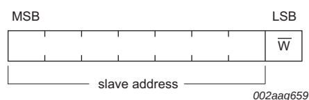
図 27. スタートプロセス後の最初のバイト
