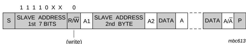
図 14. マスタ・トランスミッタによるスレーブレシーバのアドレス指定 (10 ビットアドレス)
